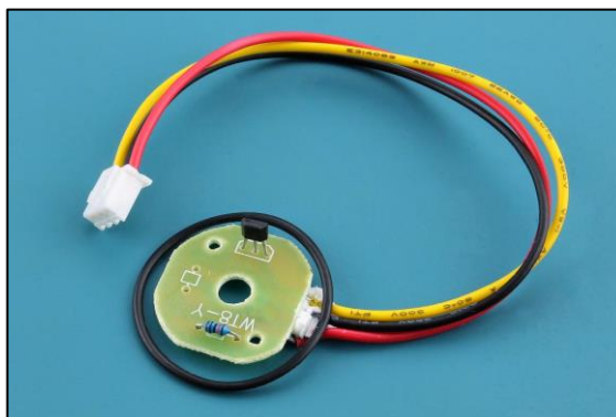
Figura 17: Sensor Hall Presente no Sensor de Fluxo de Água
