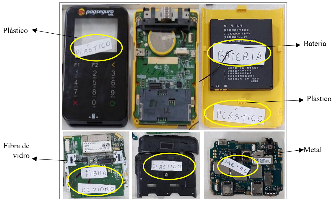
Figura 73: Componentes e materiais de uma máquina de cartão.
