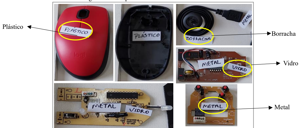
Figura 76: Componentes e materiais de um Mouse .
