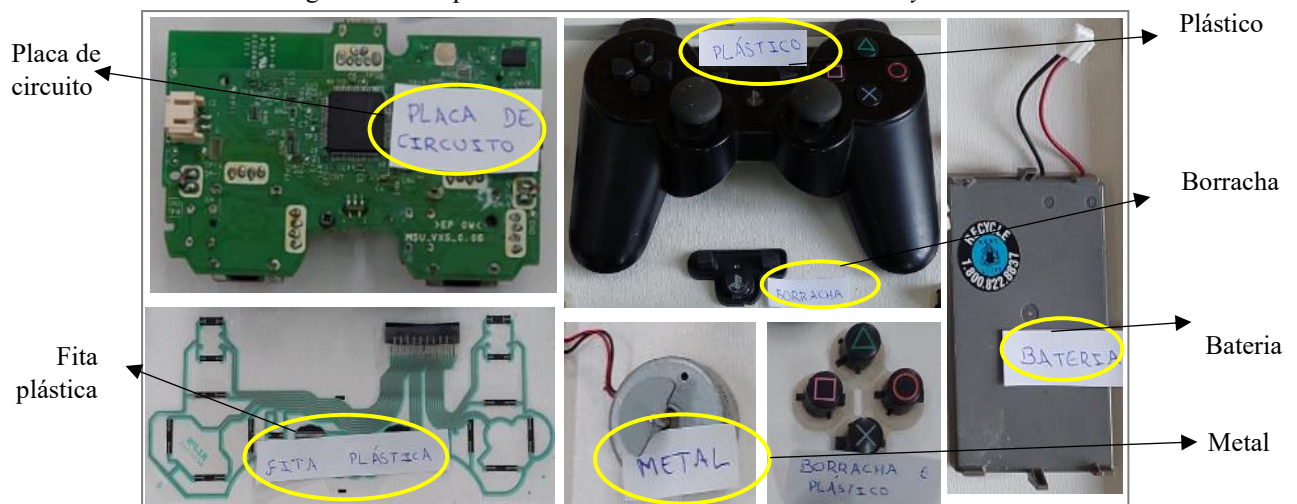
Figura 74: Componentes e materiais de um controle de Playstation .
