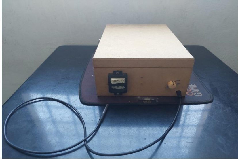
Figura 5: Alimentação, interruptor, dimmer da lâmpada e sensor ds18b20.
