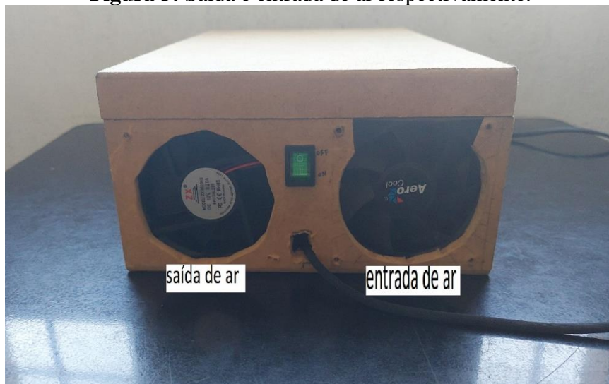
Figura 3: Saída e entrada de ar respectivamente.
