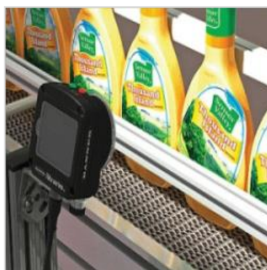
Figura 5 - Sistema de visão em fábrica de embalagens
