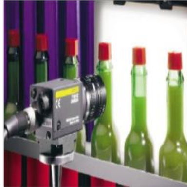
Figura 6 - Sistema de visão em fábrica alimentícia
