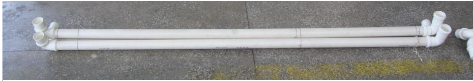
Figura 2. As junções feitas com as peças cortadas do tubo de PVC. Fonte: A própria autora.
