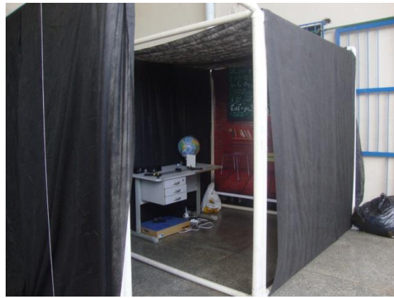
Figura 5. Estrutura com tubos de PVC coberto com TNT. Fonte: A própria autora.
