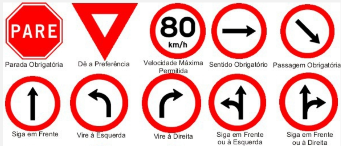
Figura 2. Sinalizações de Trânsito
