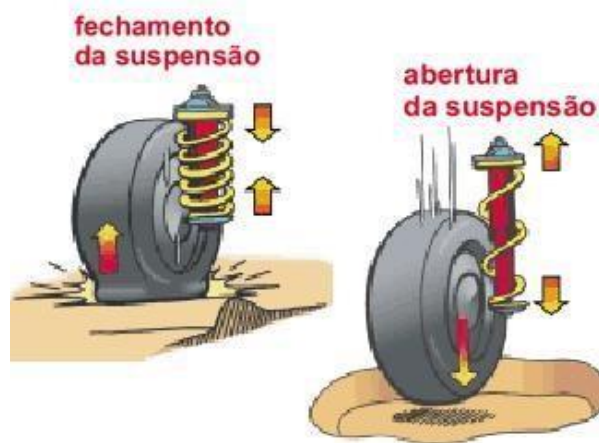
Figura 1: Ilustração do funcionamento da suspensão de um carro.
