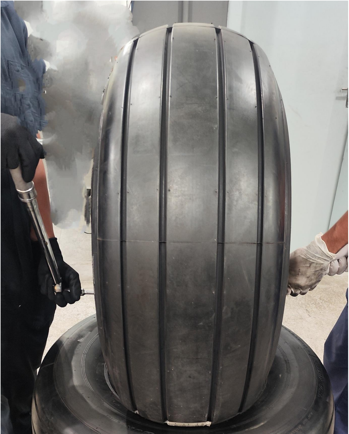
Figura 12: Montagem ou desmontagem do pneu com dois operadores: Fonte: Próprio Autor. 19/11/2022 – Manaus.
