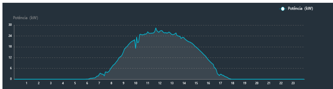
Figura 79 – Resultado extraído via software de monitoramento in loco na saída do inversor do gerador 04 .
