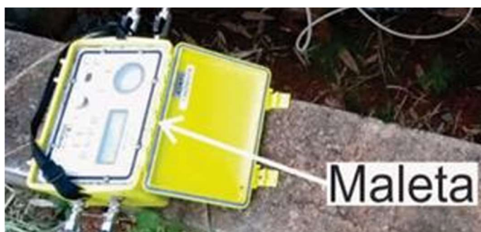
Figura 7 - Estação de pitométrica
