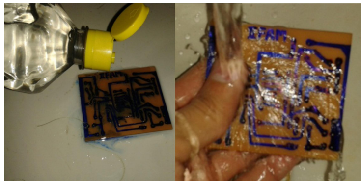
Figura 14: Limpeza da placa pós corrosão. Fonte: Autora.
