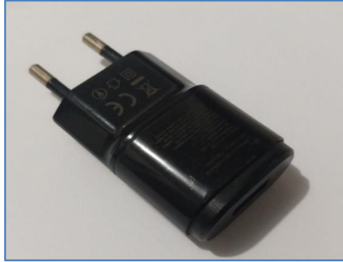
Fotografia 6 - Fonte transformadora utilizada no sistema de sonar
