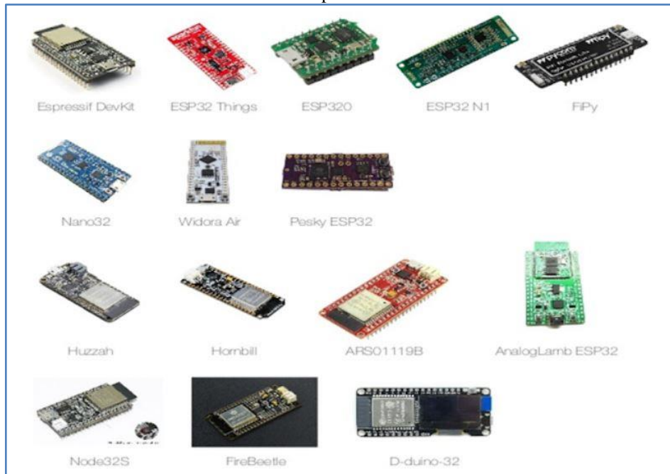
Figura 8 - Exemplos dos tipos de placas ESP32
