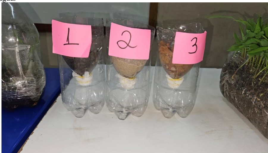
Figura 32: Amostra de diferentes tipos de solos submetidas ao teste de infiltração da água.
