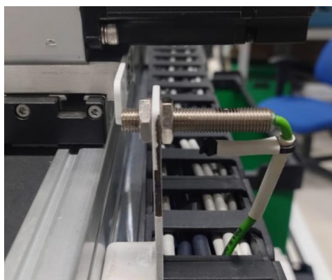
Figura 9- Sensor indutivo fim de curso do eixo X
