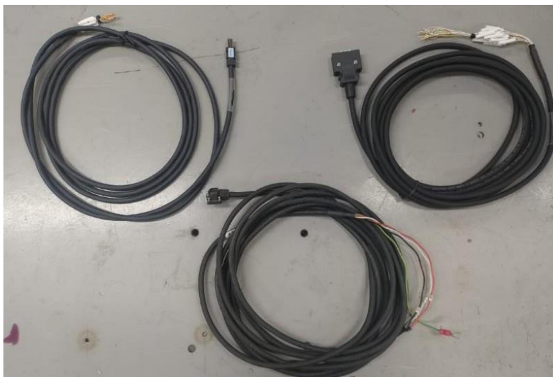
Figura 24 - Cabos para ligação dos servos motores
