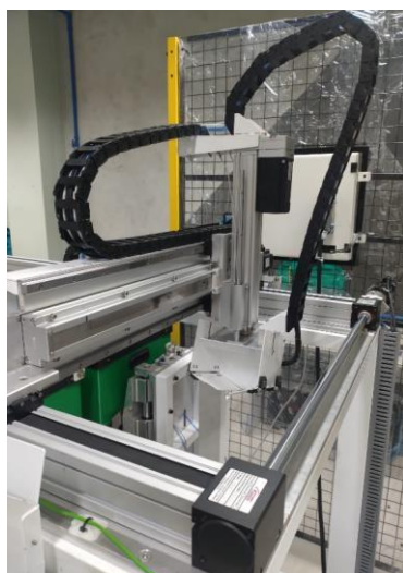
Figura 37 - Estrutura do cartesiano montada
