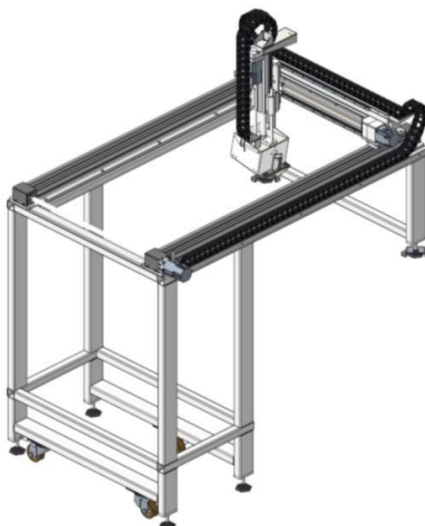
Figura 36 - Estrutura metálica do cartesiano
