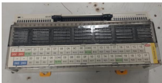
Figura 20 - Módulo expensor a distância de saída
