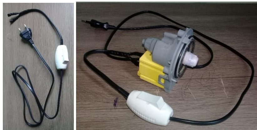
Figura 14 – Motor e circuito elétrico
