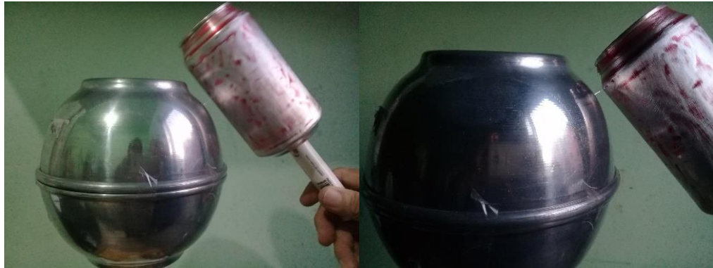
Figura 22: Quebra da Rigidez Dielétrica do Ar
