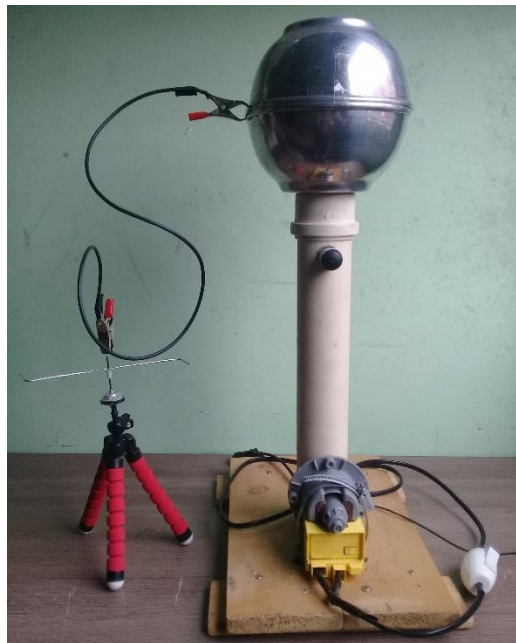
Figura 26: Torniquete elétrico conectado ao Gerador de Van de Graaff
