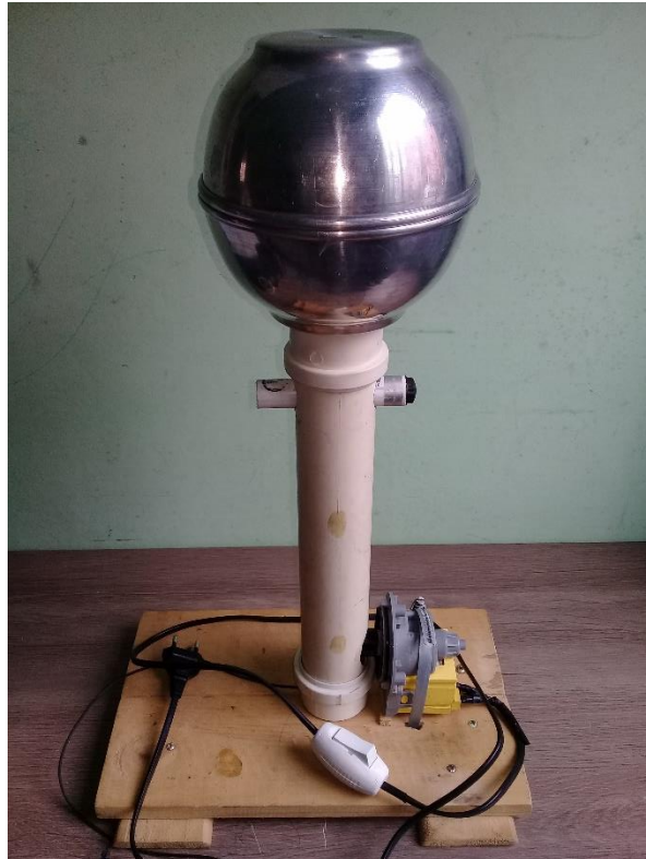
Figura 20: Gerador de Van de Graaff – Modelo Didático
