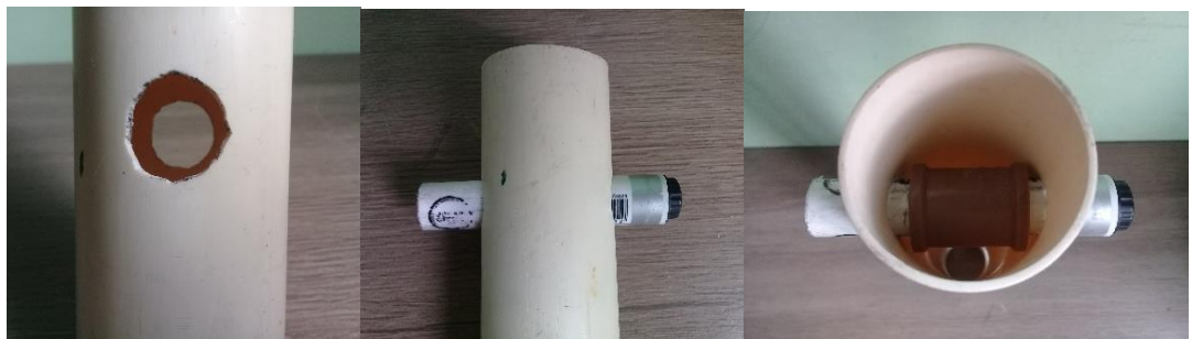
Figura 16: Construção da coluna – Rolete superior
