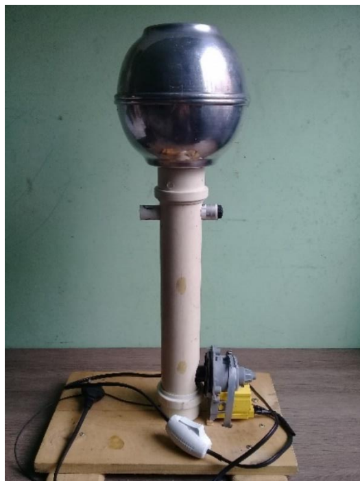
Figura 19: Gerador de Van de Graaff – Montado
