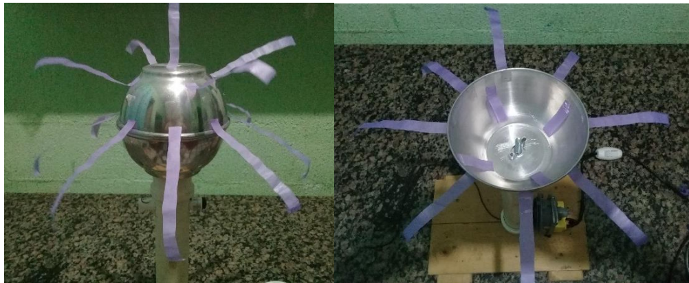
Figura 30: Ação do Campo Elétrico dentro e fora da Cúpula do Gerador
