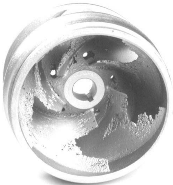
Figura 24 – Exemplo de rotor que sofreu o processo da cavitação (Fonte: KSB,1991)
