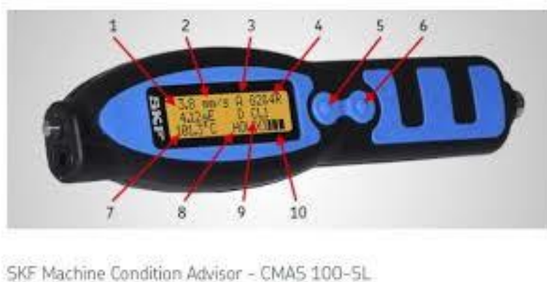
Figura 31 – Caneta para coleta de dados (vibração e temperatura) da Marca SKF (Fonte: Internet, 2017)
