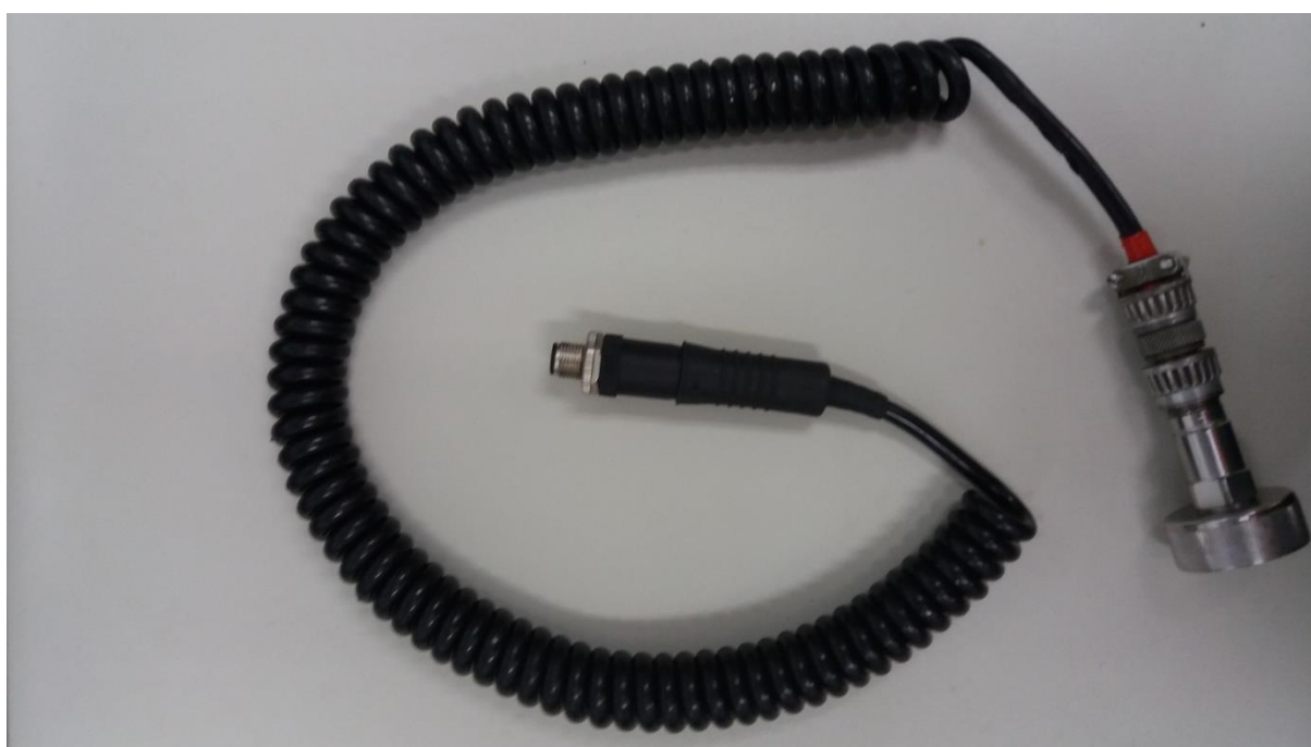
Figura 28 – Sensor de vibração (Fonte: Autor)
