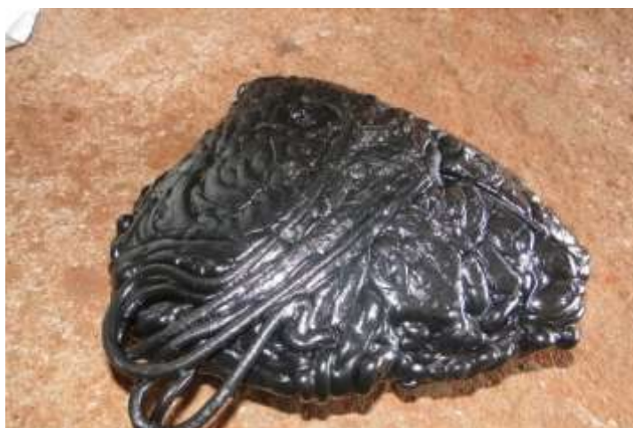
Figura 27 - Exemplo de borra de injeção
