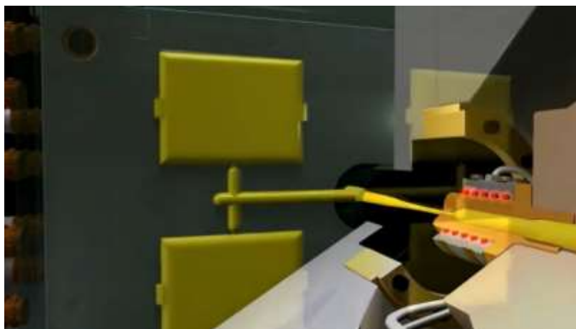
Figura 3 – Injeção plástica na cavidade do molde
