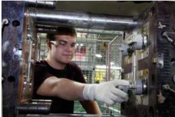
Figura 28 - Extração da peça do molde
