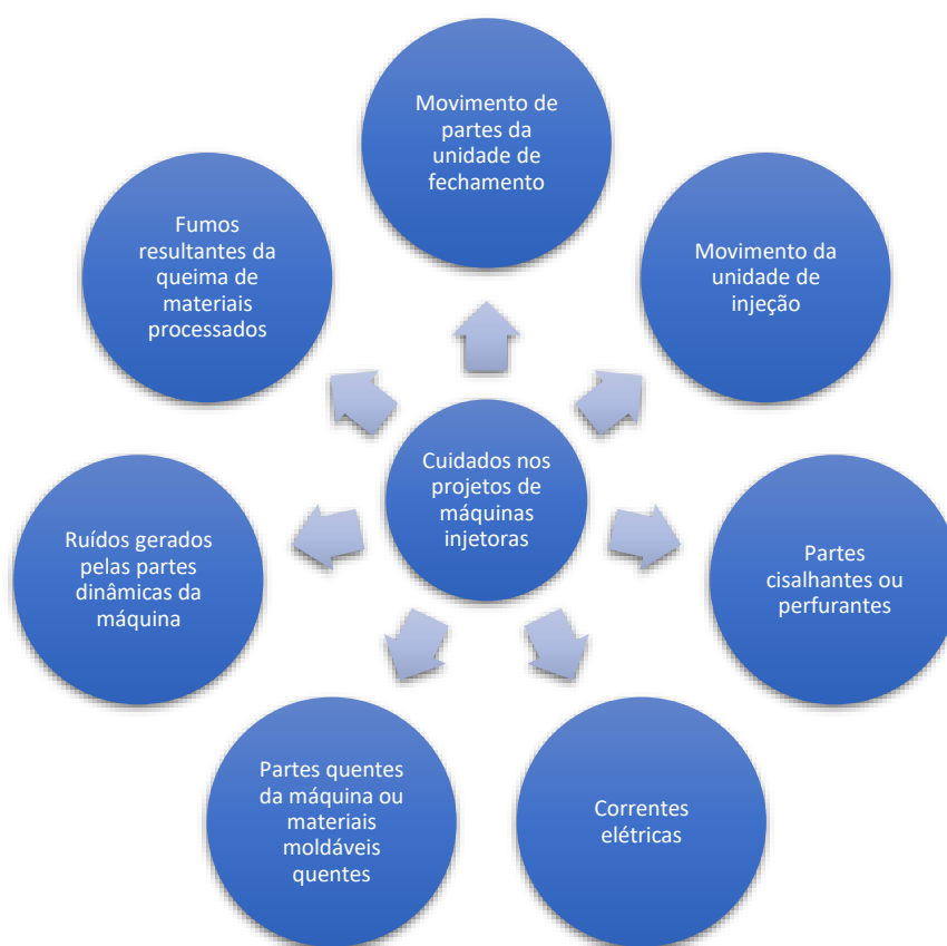
Figura 14 - Cuidados nos projetos de máquinas injetoras
