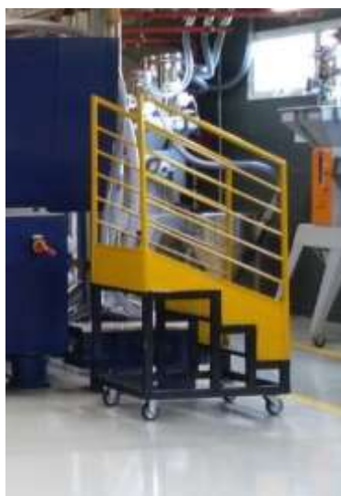
Figura 34 - Escada de acesso
