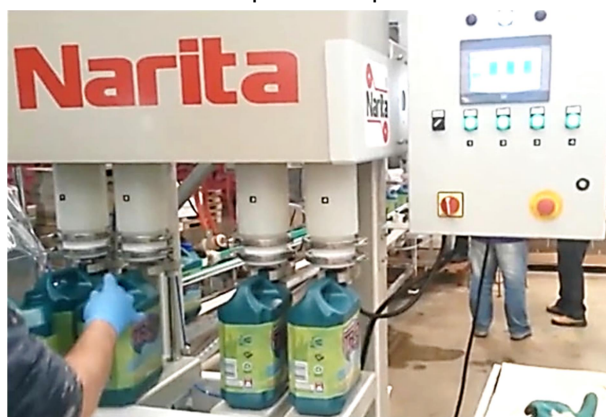
Figura 4. Envasadora de produtos químicos semiautomática.
