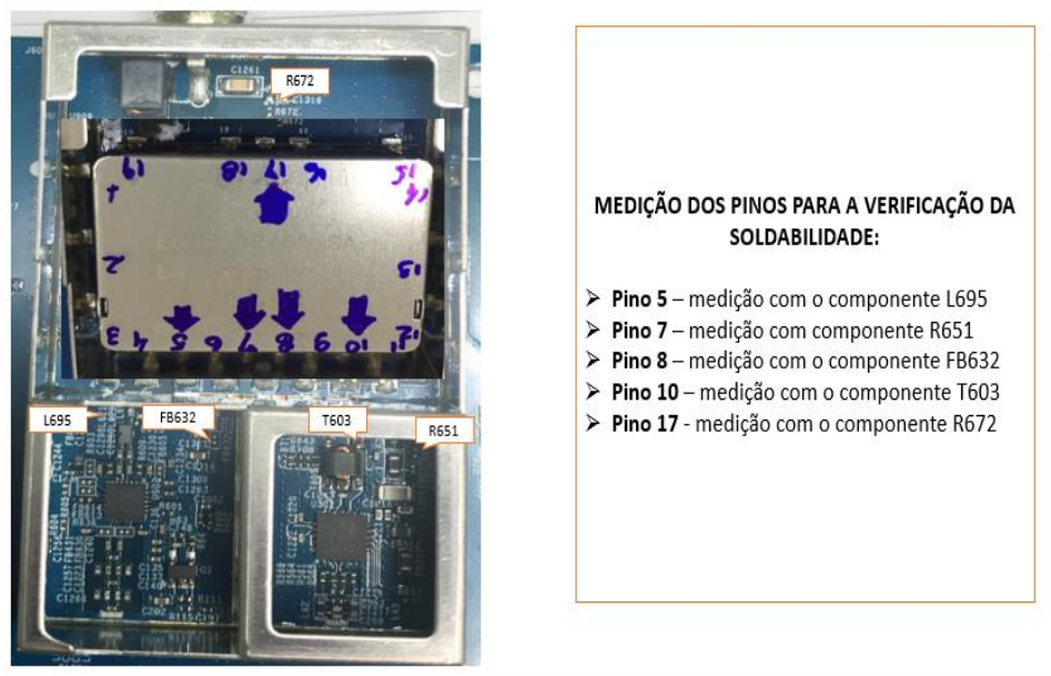
Figura 19: Medição da Soldabilidade do Diplexer
