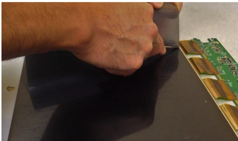
Figura 1: Extração do filme polarizador de uma tela LCD não utilizável.
