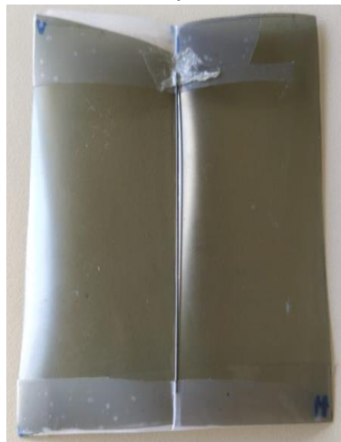
Figura 7: Identificador de caminho com a ponta de grafite para esconder a abertura entre os dois polarizadores.
