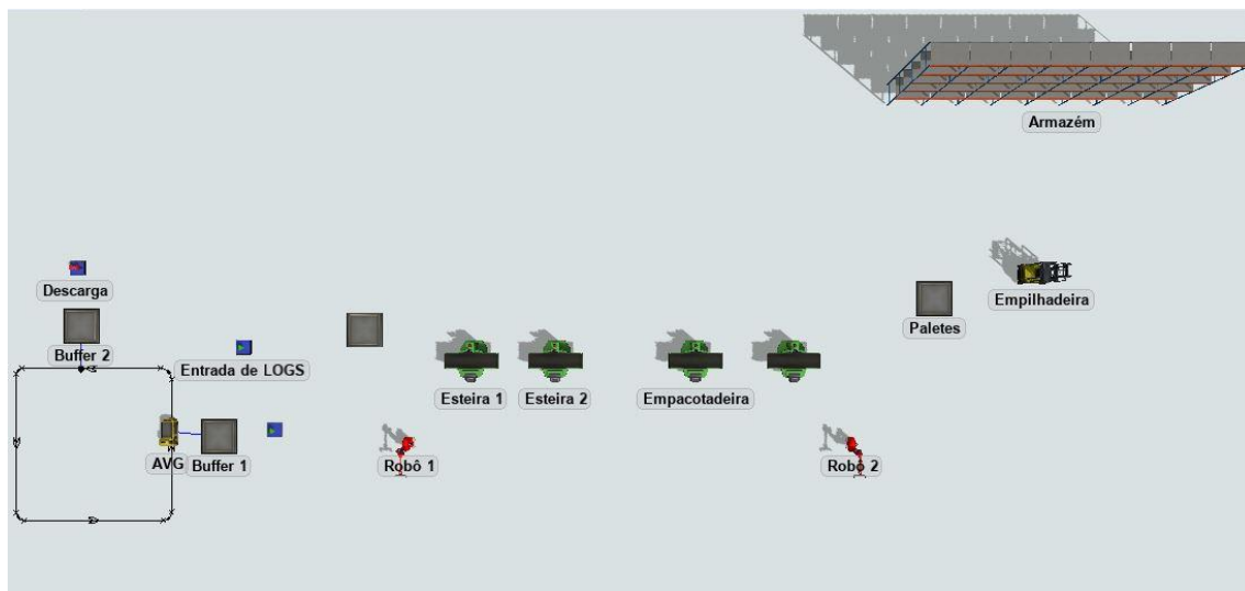
Figura 21 : Processo Automatizado de Produção da Linha de Papel Higiênico Vista de Cima
