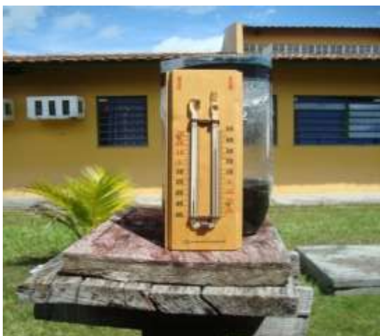
Figura 16 Local instalado o pluviômetro e o termômetro de máxima e mínima
