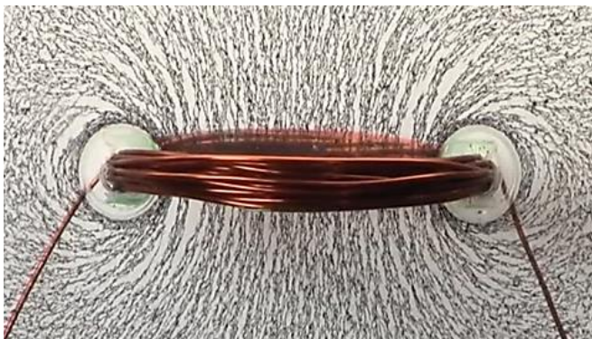
Figura 3. 11 - Espira circular, na qual circula uma corrente elétrica de intensidade i .
