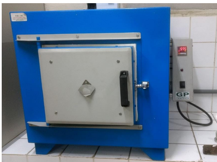
Figura 21 – Forno tipo mufla utilizado nos tratamentos.
