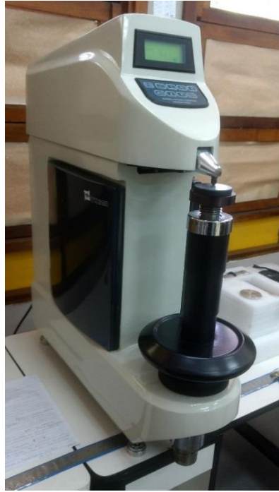
Figura 23 – Durômetro utilizado para os ensaios de dureza Rockwell B.
