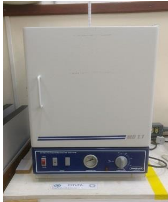
Figura 22 - Estufa utilizada no envelhecimento artificial das amostras.
