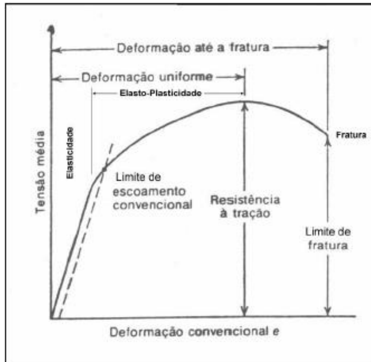
Figura 10 - Curva tensão-deformação de engenharia (Dieter, 1981 – Adaptado).
