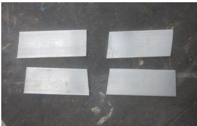
Figura 20 – Amostras cortadas para análise.
