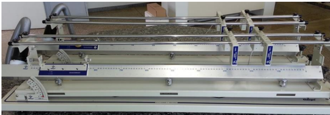
Figura 2: Trilhos de ar com sensores fotoelétricos, vista lateral.
