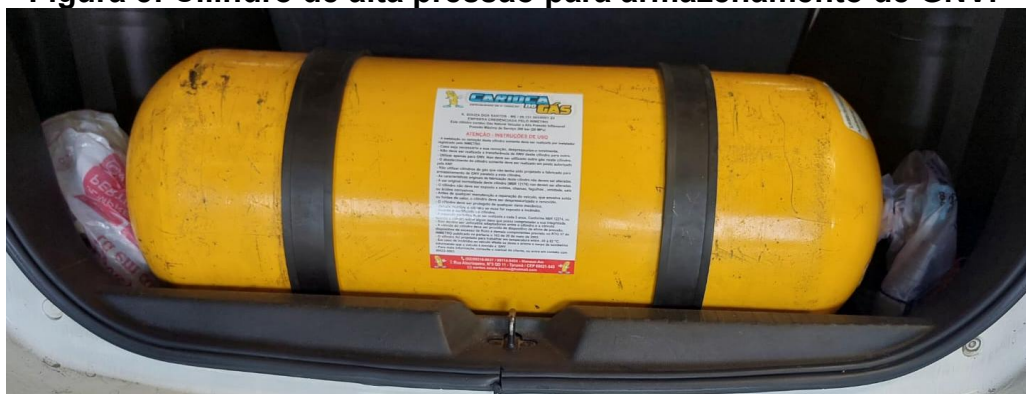
Figura 5: Cilindro de alta pressão para armazenamento de GNV.
