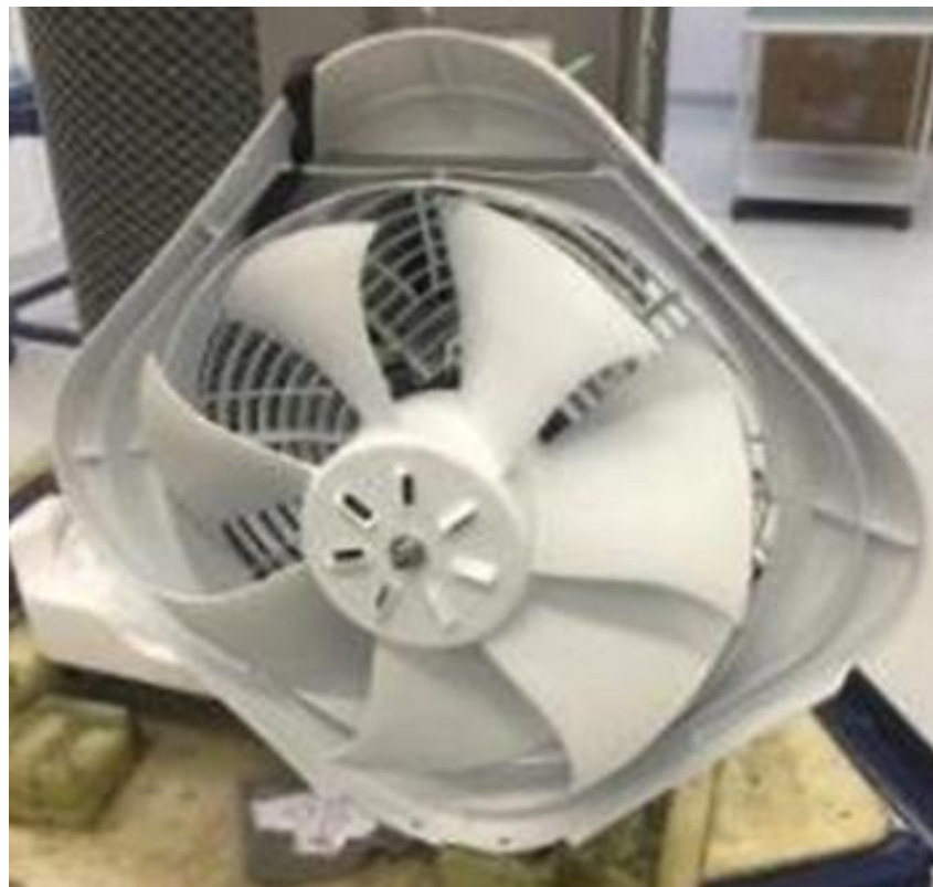
Figura 07 - Inspeção Hélice, Moto ventilador e Top do produto. Fonte - Autor: mar.2017
