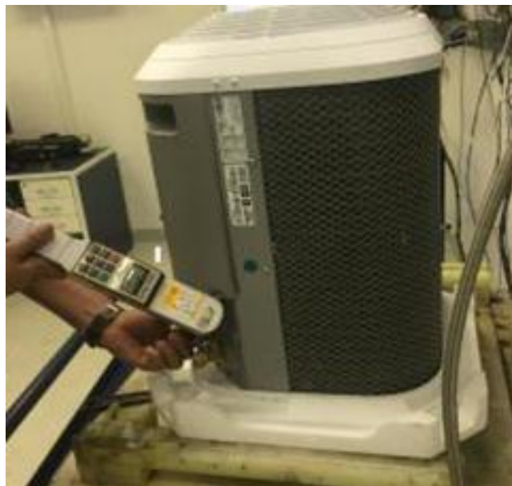
Figura 11 - Verificação de Torque Fonte - Autor: mar.2017
