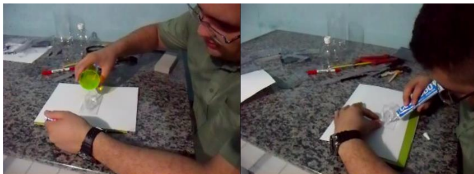
Figura 34- Montagem da lente biconvexa: teste de vazamento
