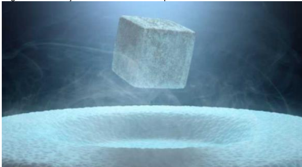
Figura 10: Levitação de material YBCO a partir do efeito Meissner-Ochsenfeld
