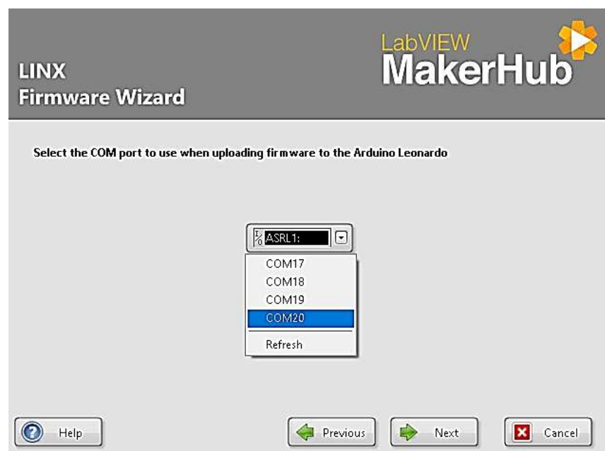
Figura 34- Seleção Da Porta Serial Em Que Se Encontra a Plataforma
