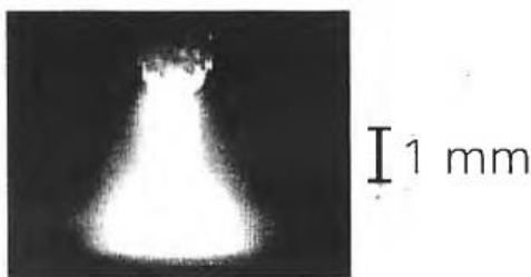
Figura 2: arco elétrico observado entre um eletrodo de tungstênio e um bloco de cobre em uma atmosfera de argônio.
