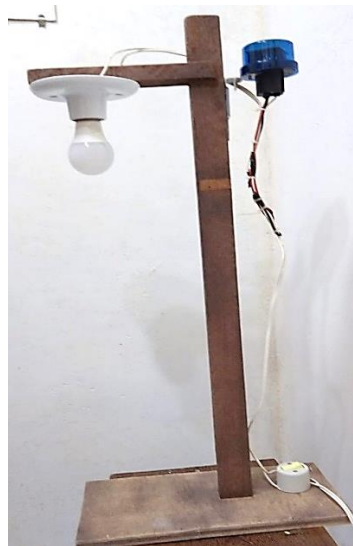
Fotografia 3: Sensor fotoelétrico de poste de luz.
