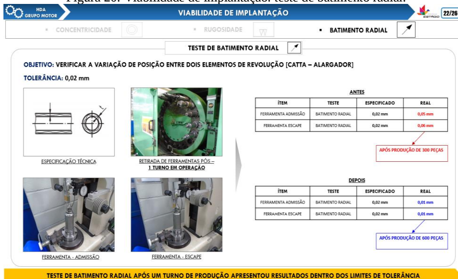
Figura 20: Viabilidade de implantação: teste de batimento radial.
