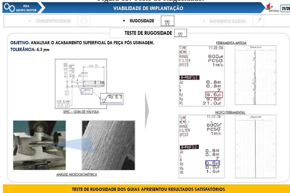
Figura 19: Teste de Rugosidade.
