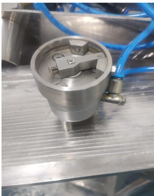
Figura 1: Atuador semi-rotativo DRVS-12-90-P. Fonte: o autor.
