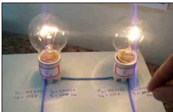
Figura 12. Experimento de associação de lâmpadas em série.
