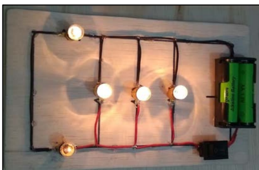
Figura 19. Simulação de associação mista de lâmpadas.
