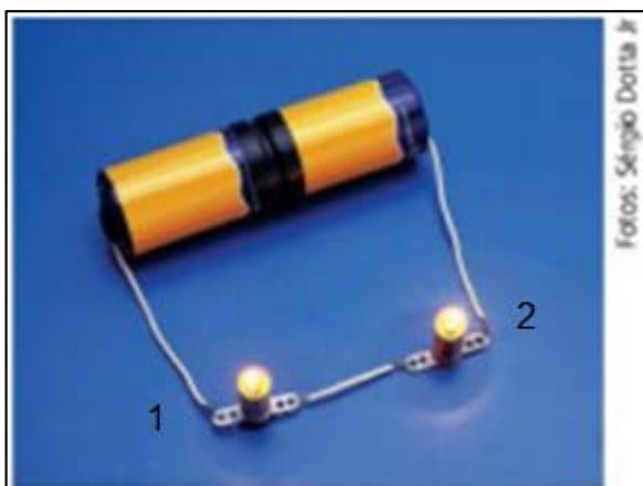
Figura 10. Imagem real de uma associação em série de resistores.
